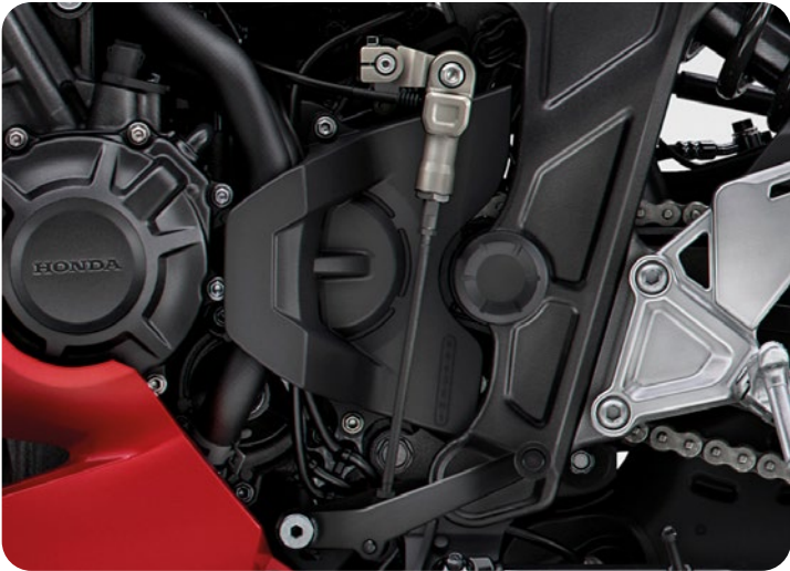
GYORSVÁLTÓ SZETT 08U72-MKN-D50 A váltás intenzitását felmelve a gyorsváltó lehetővé teszi a vezetőknek, hogy anélkül váltson sebességet, hogy működtetnie kellene a kuplungkart vagy zárnia kellene a gázt. A rendszer segíti a felváltást, ezzel is fokozva a motorozás élményét. Nem kompatibilis az E-kuplungos változatokkal.
