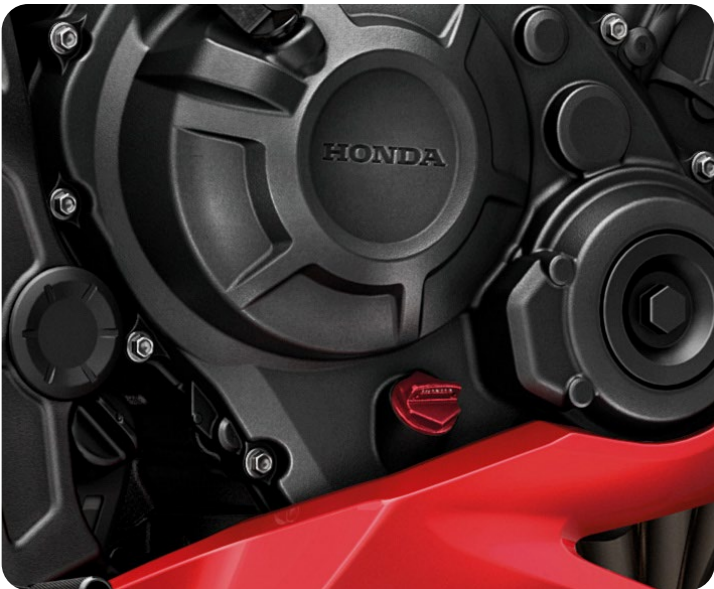
OLAJSZINTMÉRŐ 08F81-MKY-E20 Kiváló minőségű alumíniumból, precíziós vágással készült olajszint-ellenőrző. A betöltőnyílás-sapka élénk piros, eloxált felületű, és a fogó mindkét oldalán a lézergravírozott Honda logó található. Azon motorosok számára, akik pályán akarják használni a gépet, egy furatot is tartalmaz a rögzítődrót átvezetéséhez.
